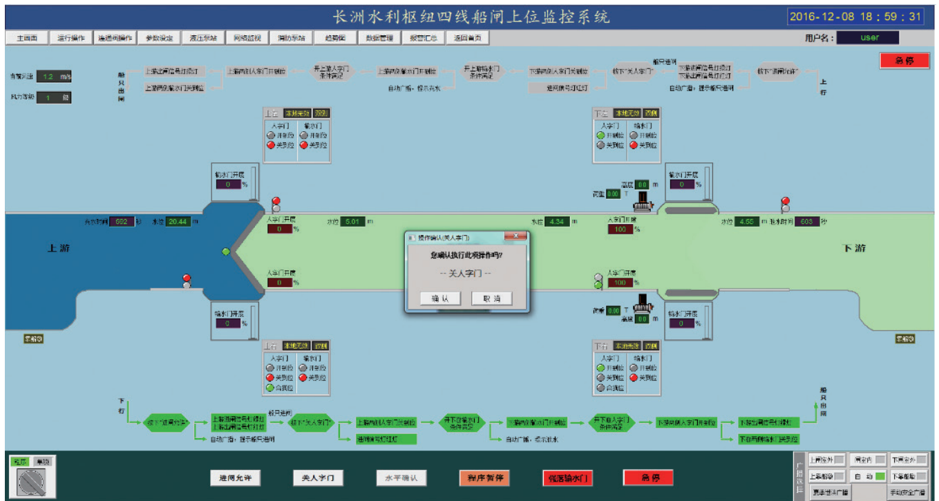
图2 长洲水利监控系统软件界面
