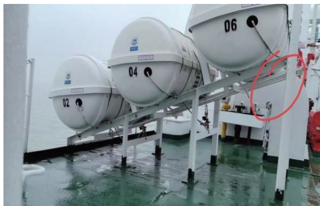
图 1 一种重力斜抛式救生筏释放装置
