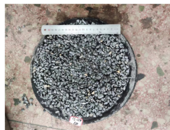
图 3 剥落率试验试件图
