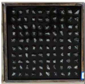
图 2 Vialit 试验试件图
