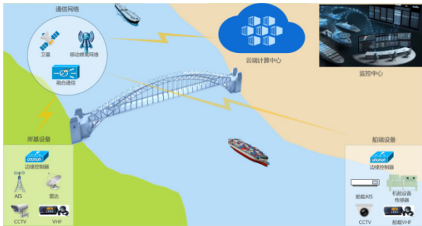
图1 船岸云协同的桥梁防撞预警系统架构示意图
