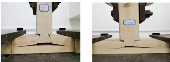
(a) 未打胶抗拉试验破坏 (b) 打胶抗拉试验破坏
