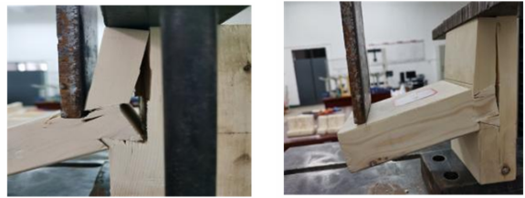
(a) 抗剪试验破坏 (b) 抗弯试验破坏
