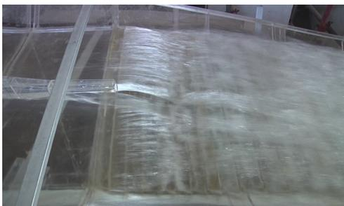
图 8 百年一遇工况下陡槽起始段水流流态照片
