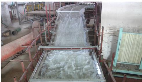
图 9 百年一遇工况下二级消力池水流流态照片
