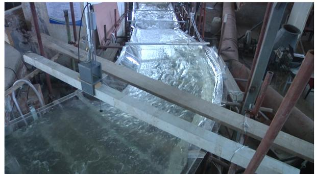
图 4 5000 年一遇洪水泄洪时转弯段水流流态
