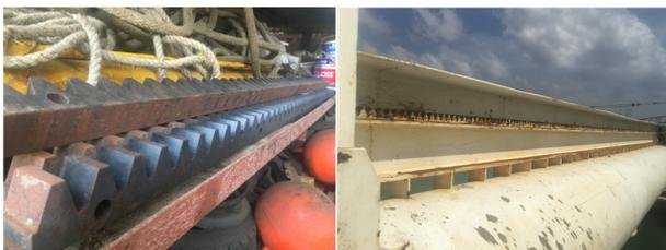
图 7 齿条及齿条安装图
