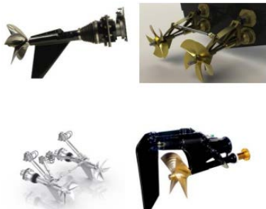
图5 国外半浸浆推进装置典型品牌外形图
