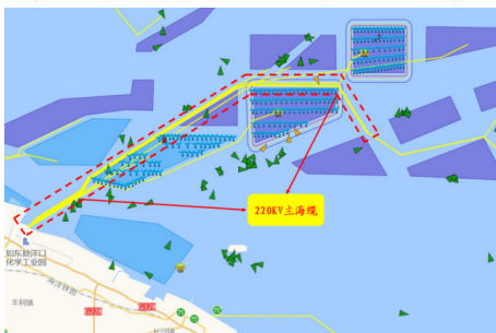
图 1 如东海上风电场 220KV 主海缆路由示意图
