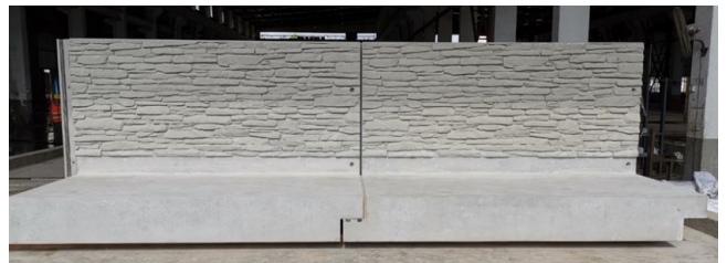
图4 预制二级挡墙样块工厂预拼装
