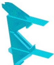
图 8 眼板支撑结构区域模型细节(靠船艏区域)
