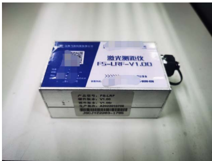
图4 FS—LRF高精度激光测距仪
