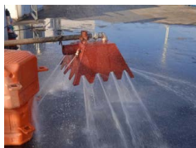
3-c 喷吸一体清淤头结构图
