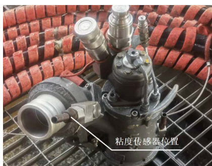
图3 抽油泵增加粘度传感器
