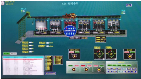
图 2 D04 仓 8# 水银高料位开关被触发
