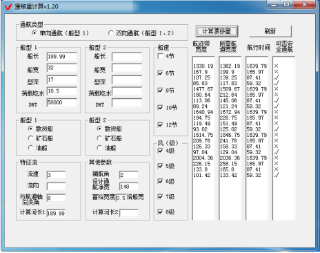
图 2 本项目 5 万吨船进出港单向航行所需航道宽度
