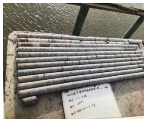
图4 桩基完整性芯样图
