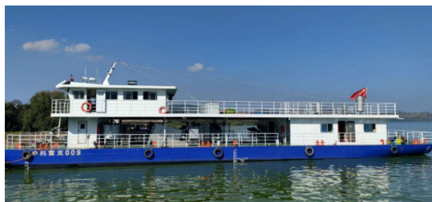
图 3 日处理 10000 吨蓝藻磁捕船
