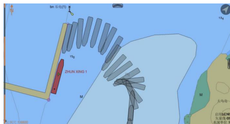
图5 案例一 突遇大风浪掉头靠泊轨迹复原图
