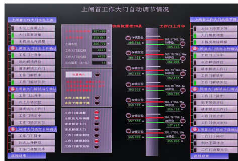
图 2 水位变化闸门调整界面图
