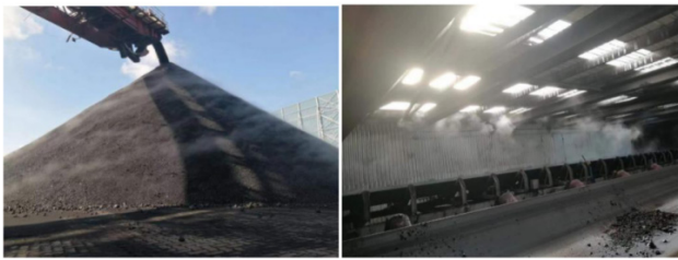
图1 煤炭进场地和皮带输送煤炭现场
