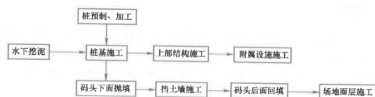
图 1. 高桩梁板码头施工流程简图
