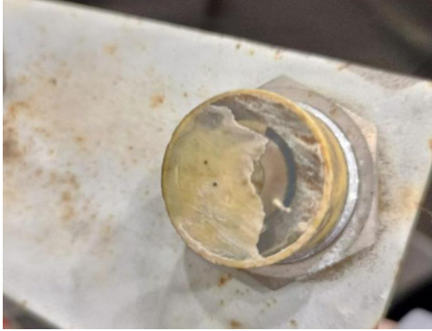
图3 撞坏的接近开关
