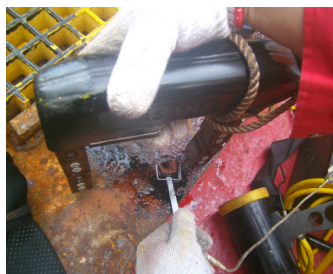
b) 磁粉检测设备进行灵敏度测试
