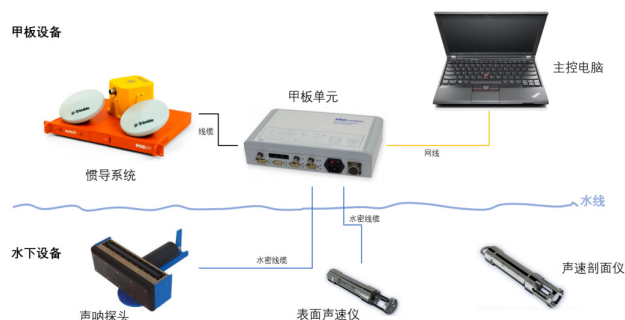
图 1 多波束测深系统组成
