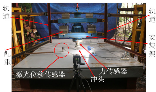
图4 冲击试验装置
