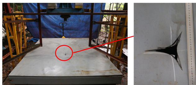
图5 原甲板板架结构冲击失效变形
