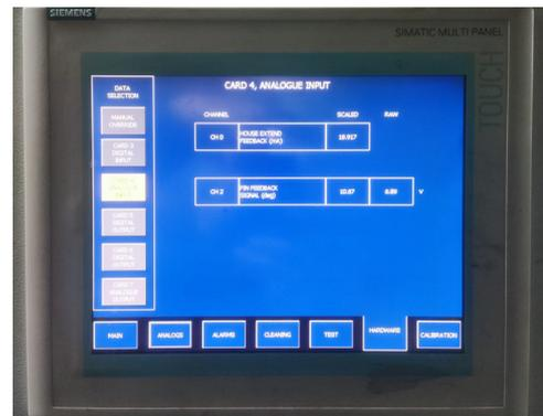
图3 左舷减摇鳍本地液晶显控单元
