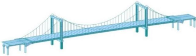
图 2 某自锚式悬索桥有限元模型图
