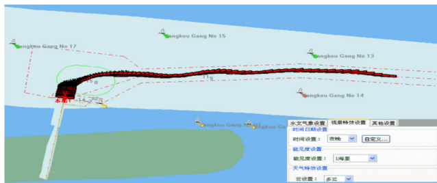
图 1 LNG 船舶满载靠泊模拟试验
