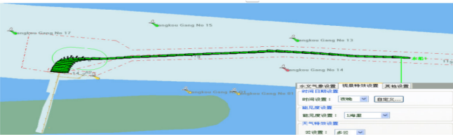
图 2 LNG 船舶压载离泊模拟试验
