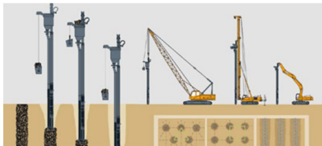
图 3 振冲施工的原理
