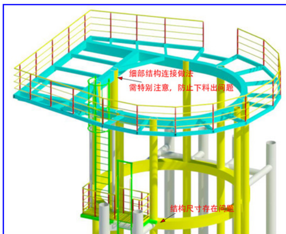
图2 集成式附属构件模型分析
