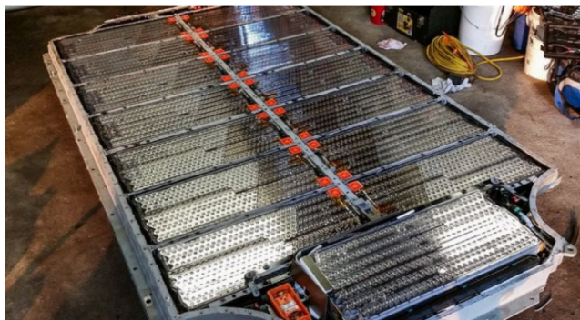
图2 特斯拉 Model S 的电池板
