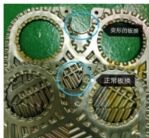
图7变形板换和正常板换对比
