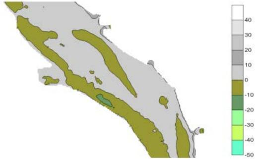
图5 Surfer 输出冲淤变化图
