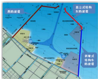
图 1 连云港港徐圩港区防波堤工程平面布置图
