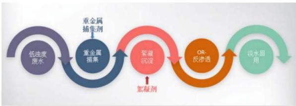
图9 废水集中回收沉淀+Ro反渗透过滤处理流程
