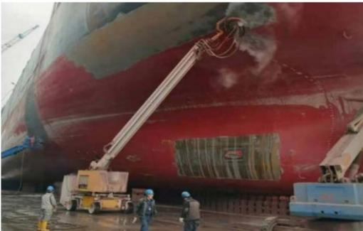
图6 遥控式升降除锈机器人 (dockmate)
