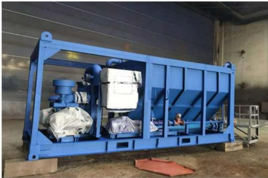
图8 废水集中回收沉淀+Ro反渗透过滤处理设备
