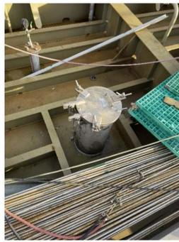
图2 直径350mm的洗舱口盖
