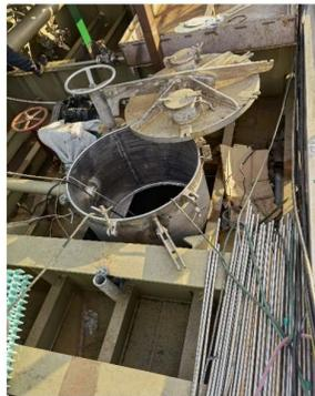
图1 直径900mm的油舱盖
