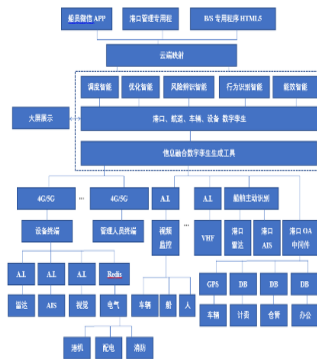
图 3 云上数字孪生服务架构
