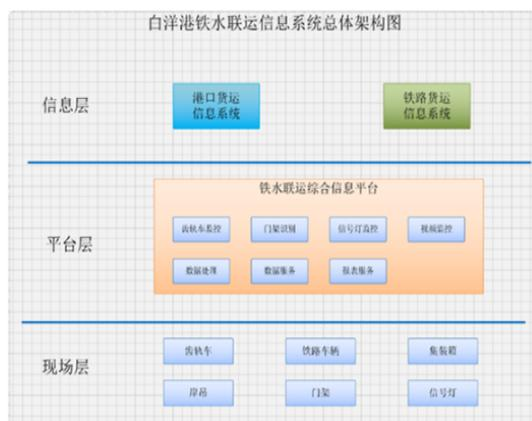
图 2 白洋港铁水联运信息系统总体框架图
