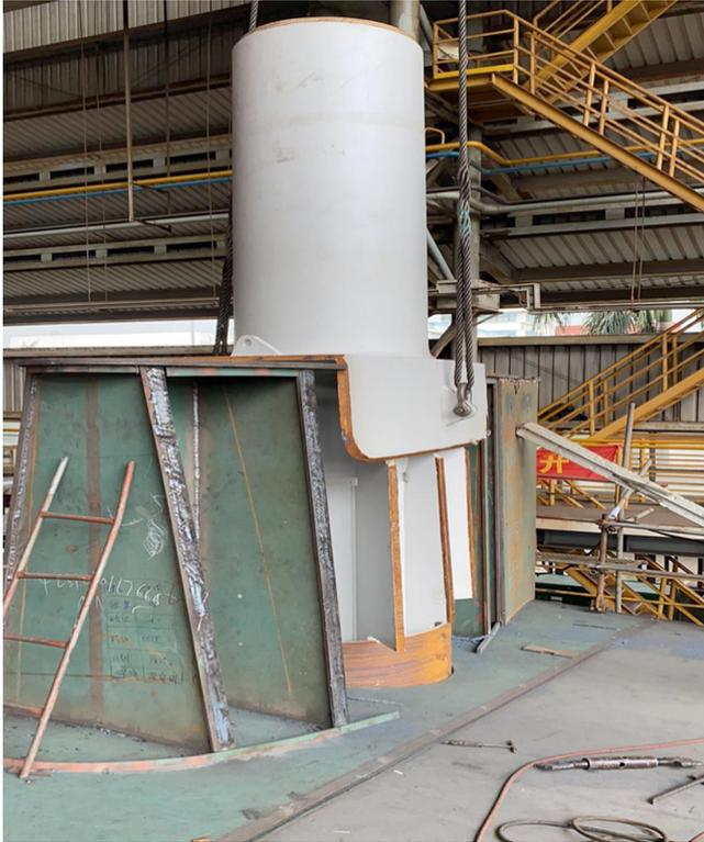
图3 德翔 2700TEU 集装箱船舵套筒分段阶段吊装定位
