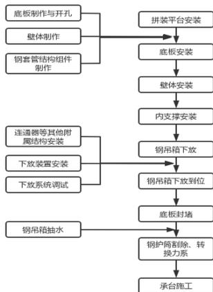
图4 总体施工流程图
