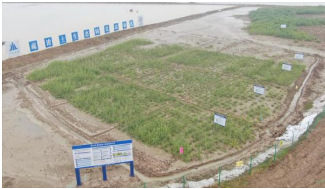
图5 疏浚土生态固化现场试验图(种植3月后航拍图)
