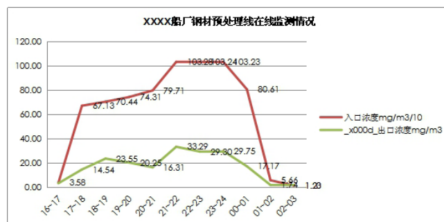
图 1 各船厂钢材预处理流水线治理运行情况分析
