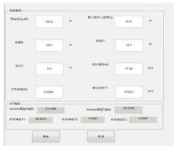
图 2 育鲲轮的 GUI 计算结果图
