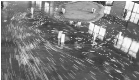
图 4 大桥左、右主墩附近流态 ( Q=25000\text{m}^3/\text{s} )
