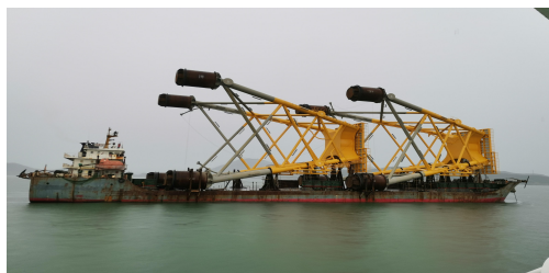
图 1 甲板驳船运输海上风电大型构件(导管架)实例
