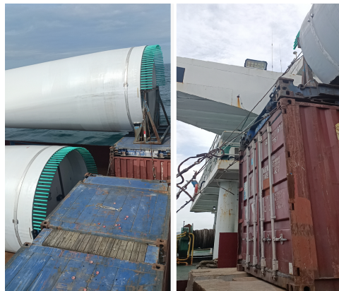
图2 海上风电大型构件绑扎实例
