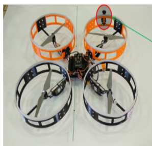
图2 安装防护罩无人机
