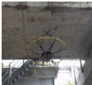
图1 安装力控制杆无人机
