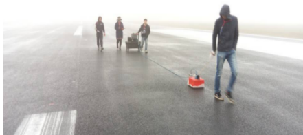
图 3 地质雷达检测现场
