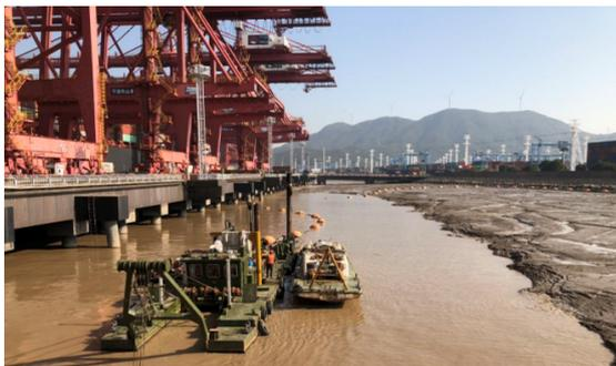
图2 拆装式小型绞吸船
