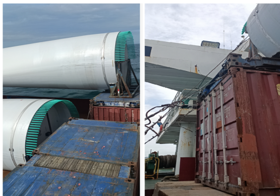
图2 海上风电大型构件绑扎实例
