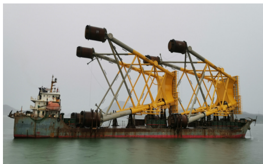
图 1 甲板驳船运输海上风电大型构件（导管架）实例
